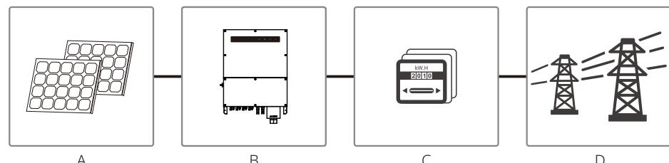
**⚠️** O motivo pela qual o inversor não pode ser conectado ao módulo fotovoltaico é que o terminal positivo ou negativo deve ser aterrado, exceto quando um transformador for utilizado entre o inversor e a rede.
