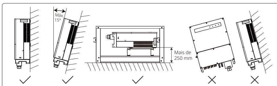
Para garantir a dissipação de calor e uma desmontagem conveniente, o espaço mínimo ao redor do inversor não deve ser inferior aos seguintes valores:
