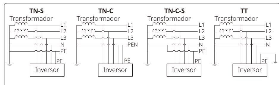
Observação: Para uma estrutura de rede TT, a tensão RMS entre o fio neutro e o fio terra deve ser inferior a 20 V.
