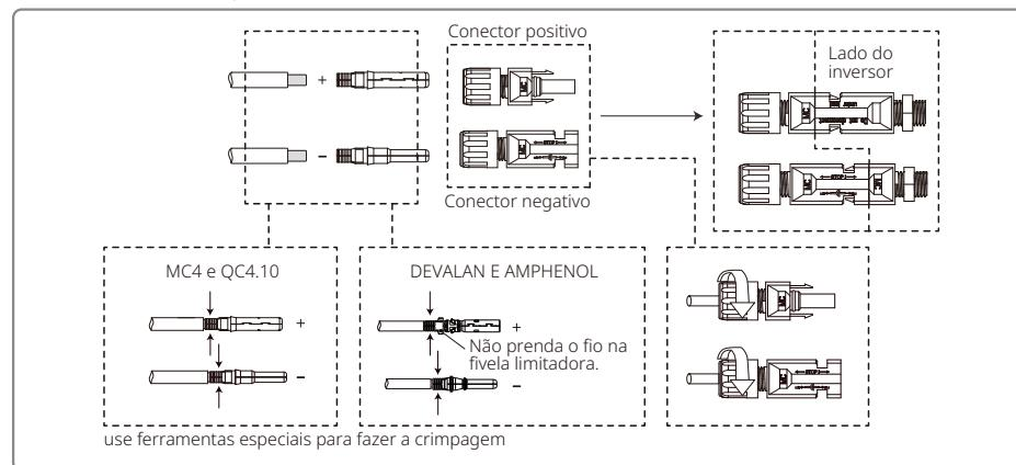
Para melhor proteção contra poeira e impermeabilização do inversor interno, todos os conectores CC fornecidos na caixa de acessórios devem ser conectados ao inversor. Se apenas alguns dos conectores CC forem usados, os conectores CC sem conexão deverão ser bloqueados com um isolador não condutor.
