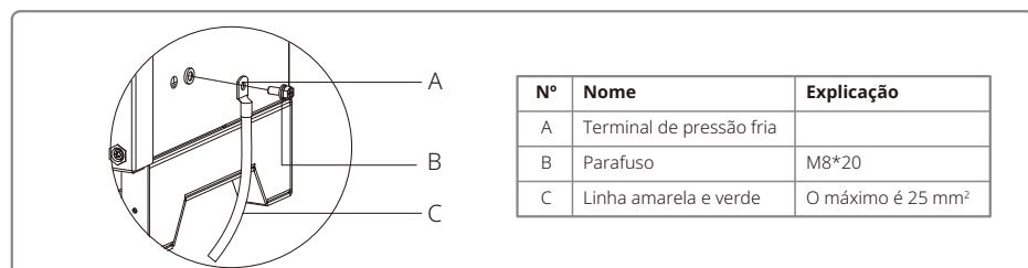
4. Para melhorar a resistência à corrosão do terminal, recomendamos a aplicação de sílica-gel no terminal de aterrimento para resistência à corrosão após a conclusão da montagem do cabo de aterrimento.
