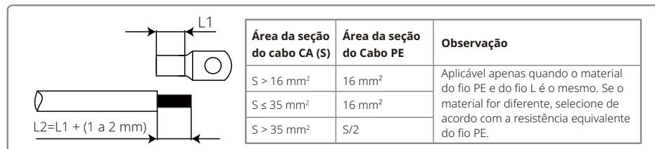
2. Insira o fio desencapado no terminal e comprima-o firmemente com um alicate de crimpagem.
