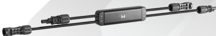
El Rapid Shutdown (RSD) consta de dos partes: receptor y transmisor. El receptor de GoodWe es un componente clave de la solución RSD 2.0 para sistemas fotovoltaicos y puede conectarse con un solo módulo. Funciona como un dispositivo de desconexión rápida a nivel de módulo y mejora la seguridad contra incendios en tejados solares y edificios.
