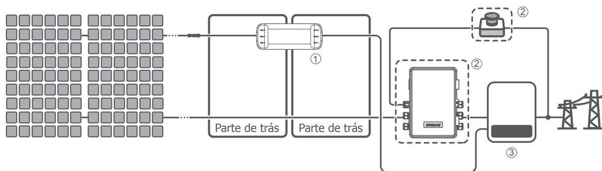
① Receptor RSD Receiver - instalado na parte traseira dos módulos
