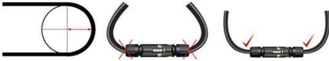
Figura 31 Raio de curvatura mínimo do cabo
