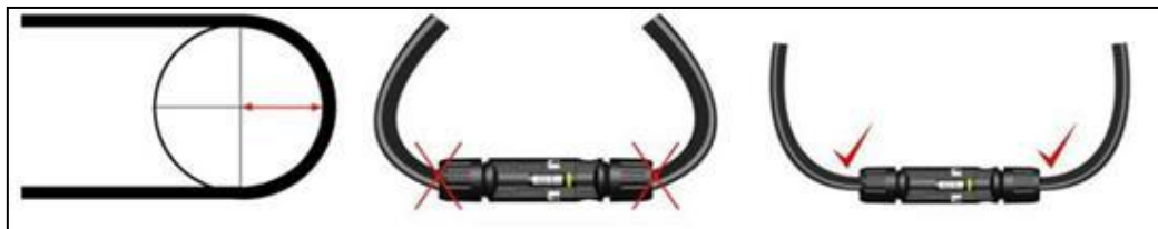
FIGURA 35 - RAIOS MÍNIMO DE CURVATURA DO CABO
