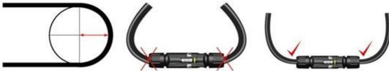
Figura 21. Raio de curvatura mínimo do cabo
